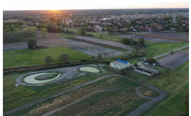
A szennyvíztisztító mellett kialakított két tómeder között az ott futó gázvezeték miatt csak felszín alatti átvezetés készülhetett (Fotó: Filmever Stúdió)
