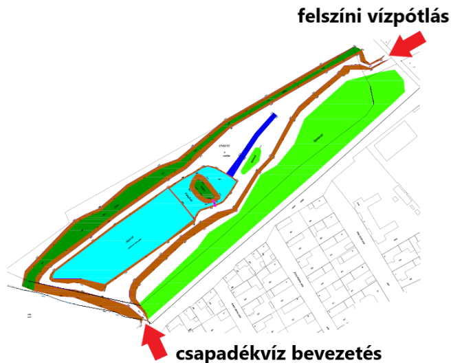
1-3. ábra A tervezési területek elhelyezkedése (fent) és a megvalósult csapadékvíz-visszatartó megoldás (balra) valamint a kapcsolódó vízpótló vezeték (jobbra) (forrás: Vízhízi létesítés engedély rajzi melléklet)
