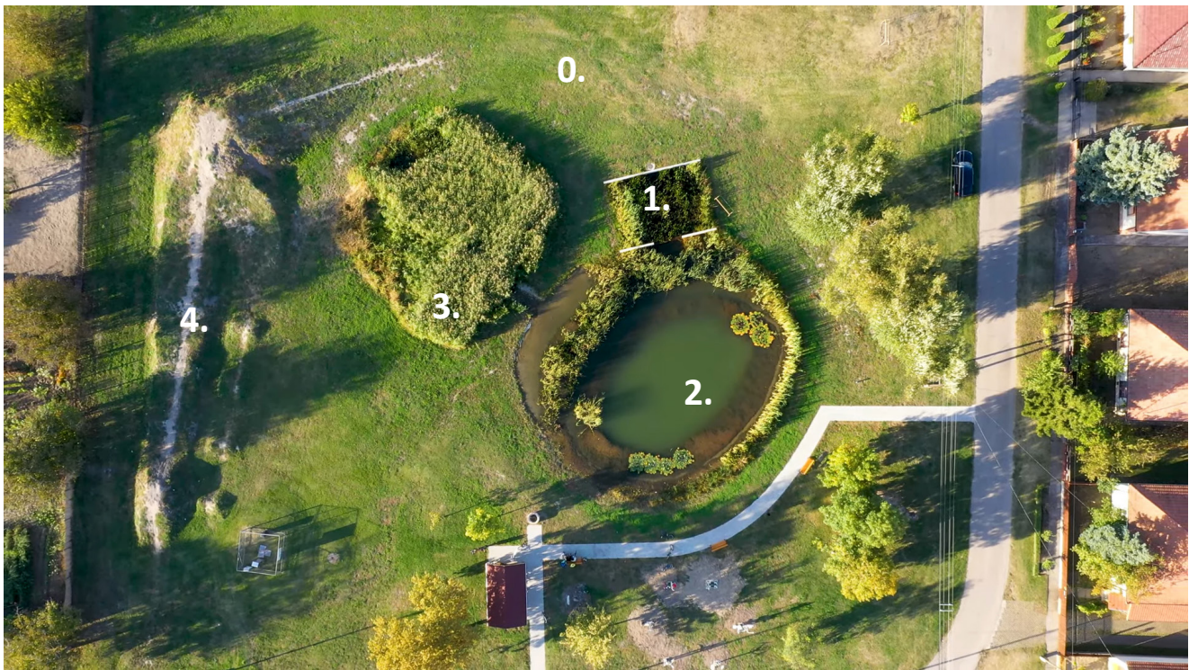
A Dózsa parkba az ivóvíztisztítóból egy nyomóvezetéken (0.) először egy ülepítőaknába (1.) érkezik a víz. Itt nagyjából egy napot tölt, majd tovább folyik a részben kifóliázott tómederbe (2.), ahonnan túltöltődés esetén egy már korábban is meglévő nádasba folyik át (3.), és szikkad el. A kitermelt földből a parkban BMX-domb (4.) épült. (Fotó: Filmever Stúdió)
